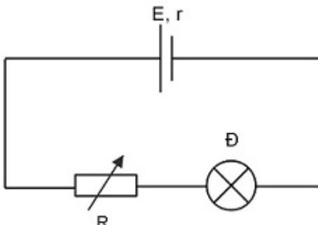
Nguồn điện có suất điện động  $E = 9 \text{ V}$  và điện trở trong  $r = 1 \Omega$ . Đèn có ghi  $6 \text{ V}-3 \text{ W}$ . Bỏ qua điện trở của dây nối. Giá trị của biến trở  $R$  để đèn sáng bình thường là
