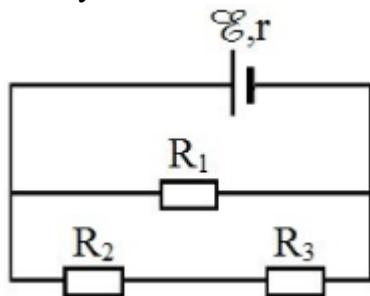
Biết  $E = 12V$ ;  $r = 1 \Omega$ ;  $R_1 = 5 \Omega$ ;  $R_2 = R_3 = 10 \Omega$ . Bỏ qua điện trở của dây nối. Hiệu điện thế giữa hai đầu  $R_1$  là
