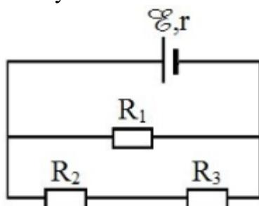
Biết  $E = 12V$ ;  $r = 1 \Omega$ ;  $R_1 = 5 \Omega$ ;  $R_2 = R_3 = 10 \Omega$ . Bỏ qua điện trở của dây nối. Hiệu điện thế giữa hai đầu  $R_1$  là
